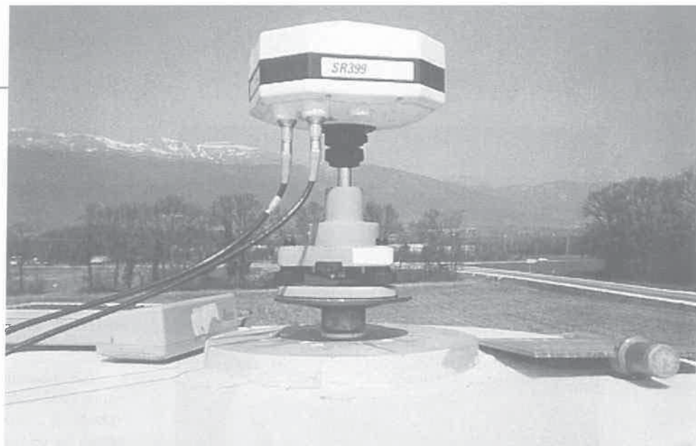
Photo 1 — Embase universelle équipée d'une antenne
