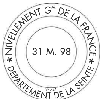
Fig. 7 : Repère du département de la Seine sur le bureau de l'octroi du Bas-Meudon (n° 745 alt. 31,98, repris par le nivellement LALLEMAND sous l'immatriculation Pa a 3 d 3 10, altitude 31,341).
