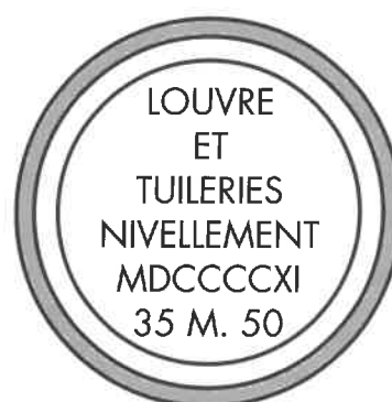
Fig. 11 : Repère de nivellement Louvre et Tuileries, d'un diamètre 117 mm.
