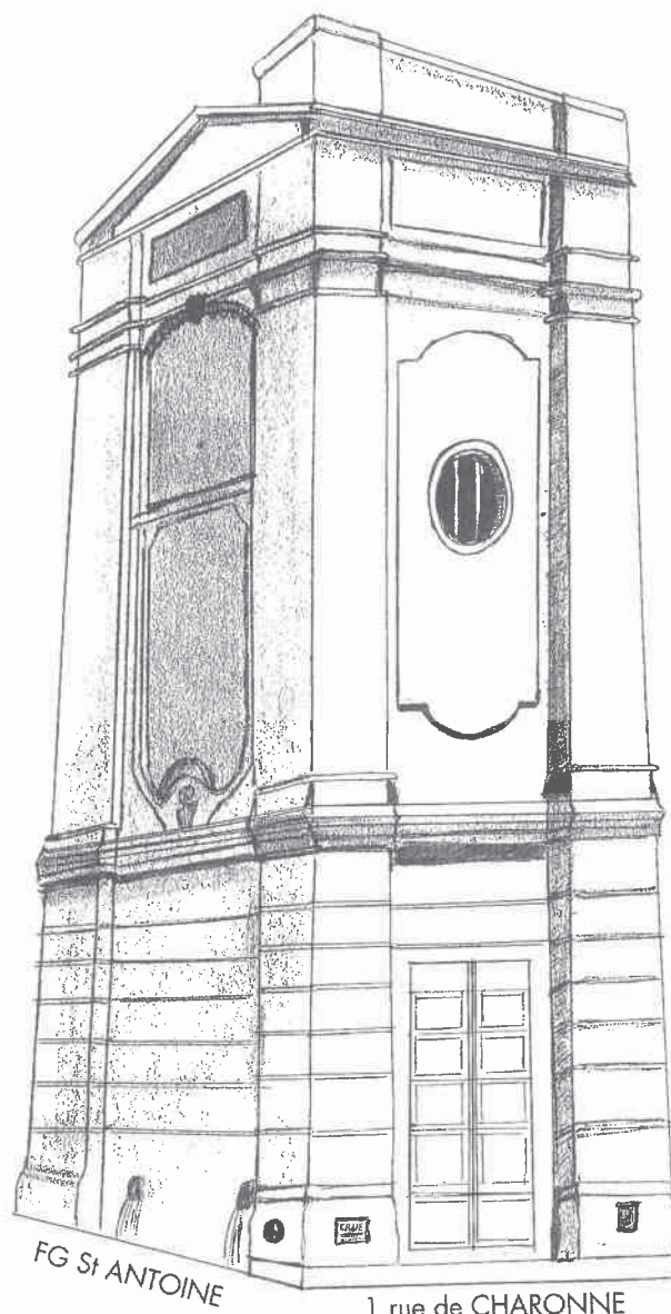
Fig.13 : La Fontaine Trogneux, à l'angle de la rue du Faubourg St Antoine et de la rue de Charonne, date de 1710. Elle porte un repère Ville de Paris n° 43058 à 34,277 m, une plaque de crue "janvier 1910" à 34,24 m et une petite plaque de nivellement n° 61 à 34,44 m.
