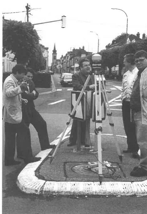
fig. 5 – La récepteur GPS centré sur le regard du refuge du carrefour des routes de Paris et de Brie, endroit présumé du terme austral de la base de Delambre.
