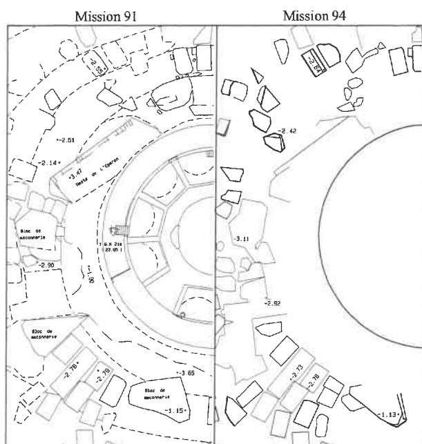
Fig. 1 – Extrait de plan côté éperon avec quelques cotes altimétriques afin d'éviter une surcharge graphique
