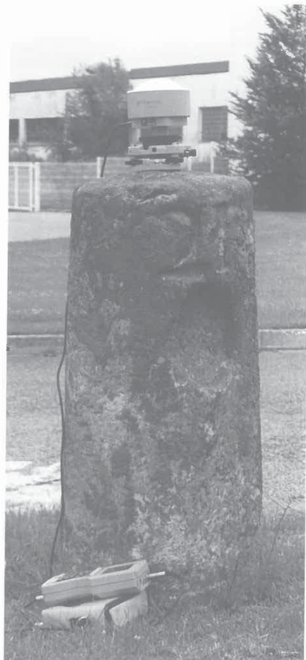
fig. 6 – La borne milliaire 21 à Vert-St-Denis, en place depuis plus de 220 ans au bord de l'actuelle RN 6, surmontée du récepteur GPS. D'un diamètre de 16 pouces (43 cm) et de 4 pieds de hauteur (130 cm), la borne portait dans un ovale en creux situé sous la chiffreson, une fleur de lys en relief, marquant la qualité royale de la route. Cet ornement a été martelé à la Révolution.
