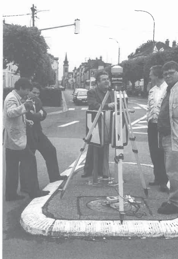
fig. 5 – La récepteur GPS centré sur le regard du refuge du carrefour des routes de Paris et de Brie, endroit présumé du terme austral de la base de Delambre.
