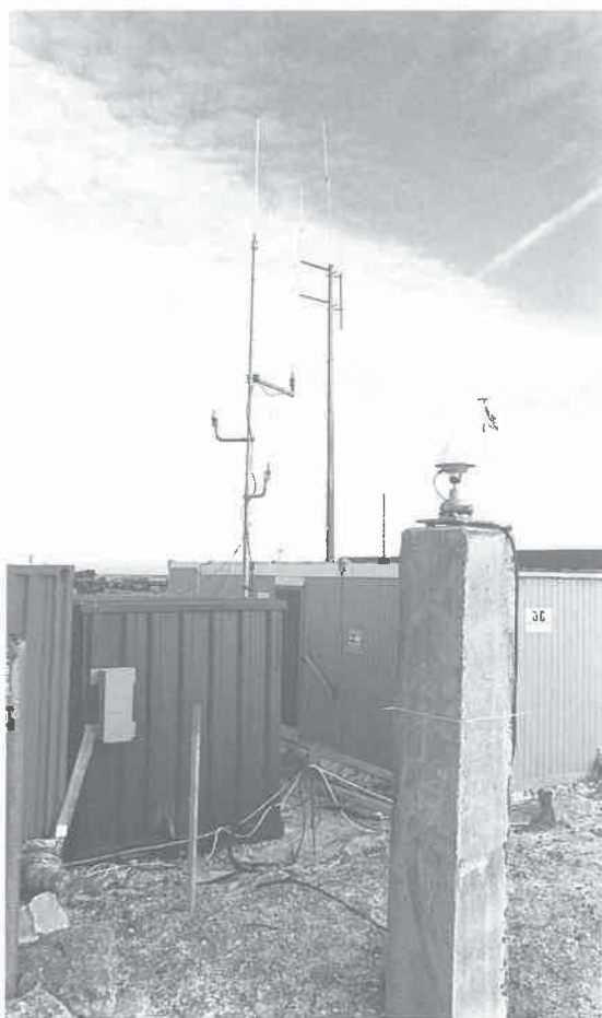
Un des postes de référence permanents sur l'île artificielle. Il est équipé d'une antenne pour la transmission de données et d'une antenne GSM. Afin d'éviter que les oiseaux ne causent des interférences, l'antenne GPS a été couverte d'un revêtement spécial.
