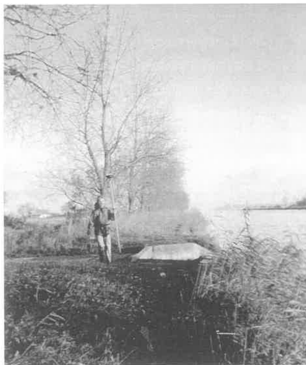
Rangée d'arbres rendant aléatoire le levé des points ( fonction de la configuration spatiale des satellites )
