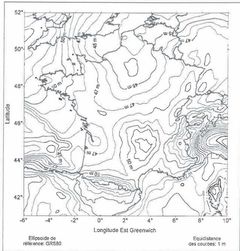
Après plusieurs années d'études menées au Laboratoire de Recherche en Géodésie de l'IGN et à l'ESGT, et avec l'appui décisif du Bureau Gravimétrique International, un nouveau modèle de géoïde couvrant la France continentale vient d'être calculé.
