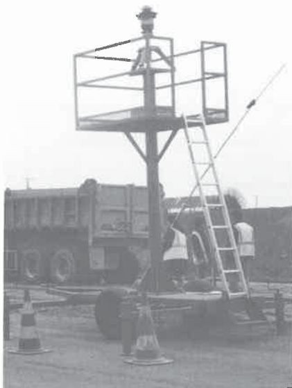
1. Trois lasers rotatifs double pente placés sur remorques avec stabilisateur
