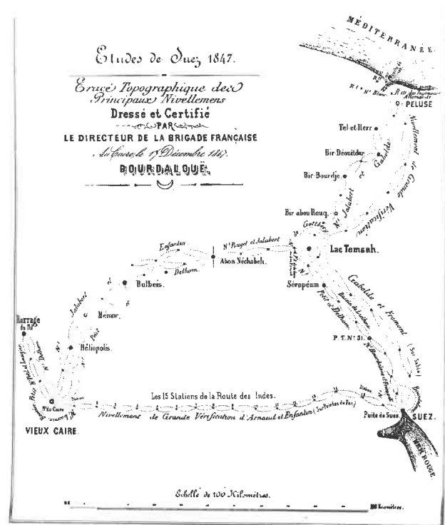
Figure 8 : Tracé topographique des principaux nivellements de 1847, en Égypte.
