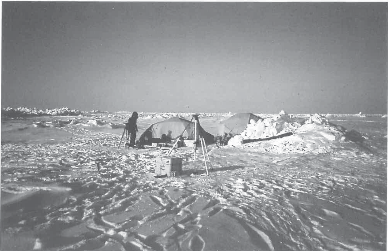
Camp de base - Avec le Trimble 4000ssi pour enregistrer les mouvements de la banquise
