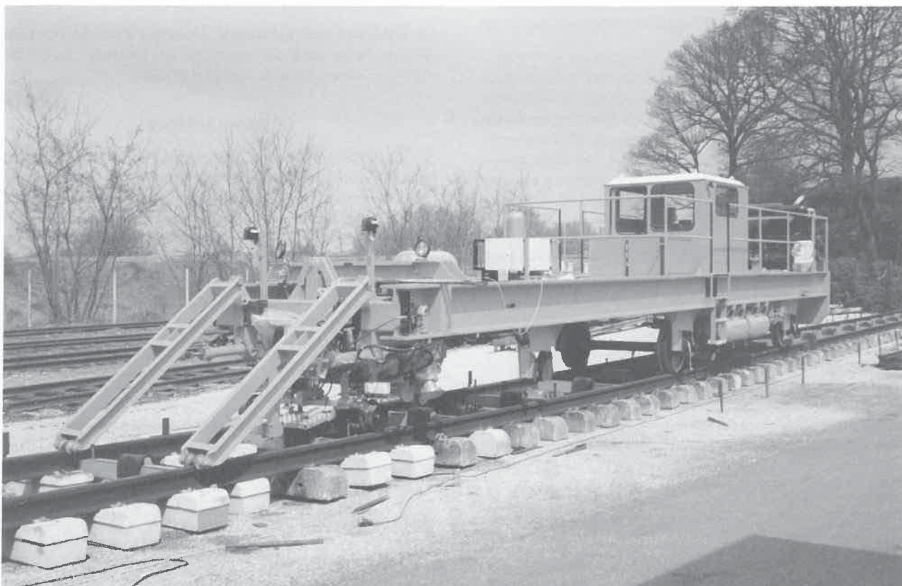
Machine de pose de voies RND 92
