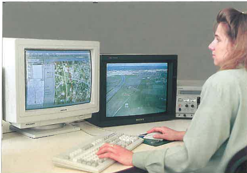
2. Poste de travail NADAR. De gauche à droite: l'écran du micro-ordinateur avec la cartographie numérisée, le téléviseur avec l'image vidéo oblique et le lecteur de vidéo-disque laser.
