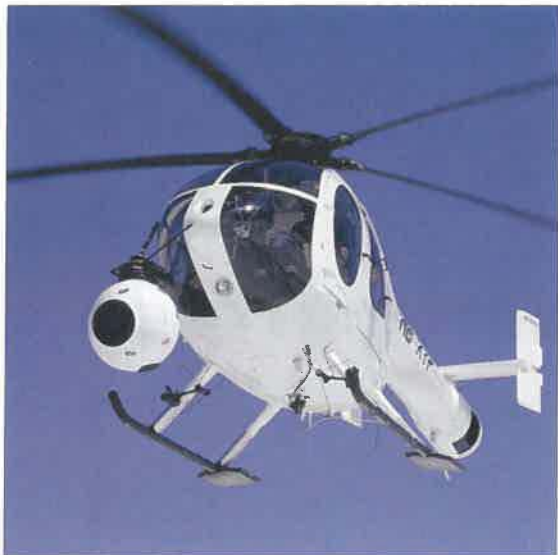
1. L'hélicoptère et la boule WESCAM contenant le plateau stabilisateur et la caméra haute définition.
