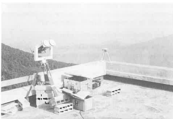
Photo 1 : Radiomètre à vapeur d'eau orientable ETH-CAPTEC (à gauche) et antenne GPS (à droite) en cours d'acquisition à la station météorologique du Mont Aigoual.
