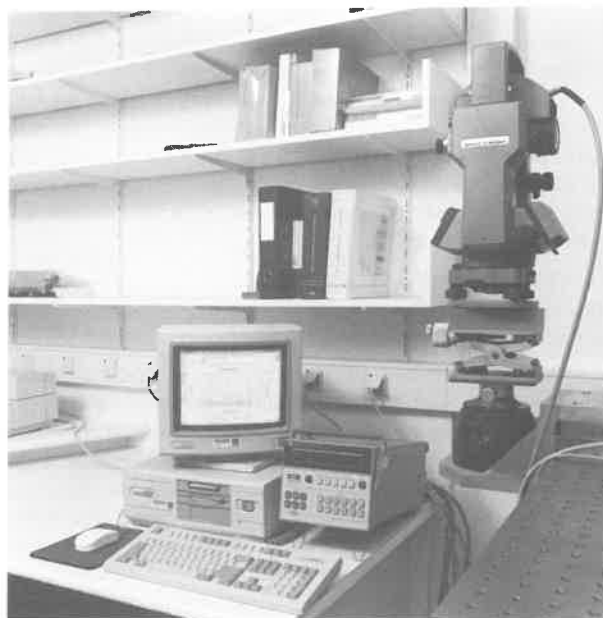
Figure 5 : Photo de la station micror-informatique de pilotage et d'acquisition.
