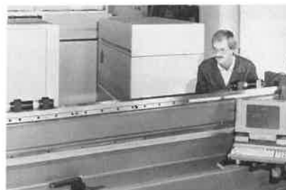
Mesure de la rectitude d'une poutre
