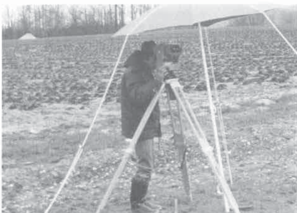
Rattachement par relèvement à la triangulation générale de la France d'un repère d'axe de piste - aérodrome de Saverne - Steinbourg - travail exécuté par la cellule topographique - photographie de Pierre Bijou
