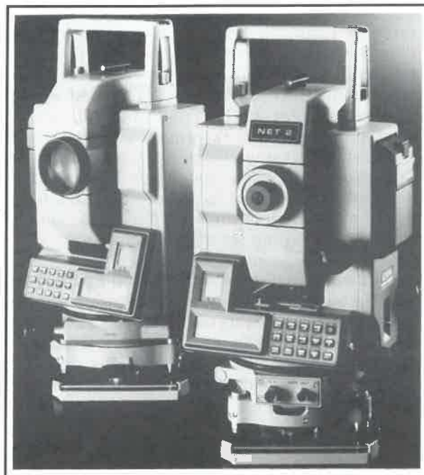
NET 2 : Télémètre intégré - Colimation multi-axes
