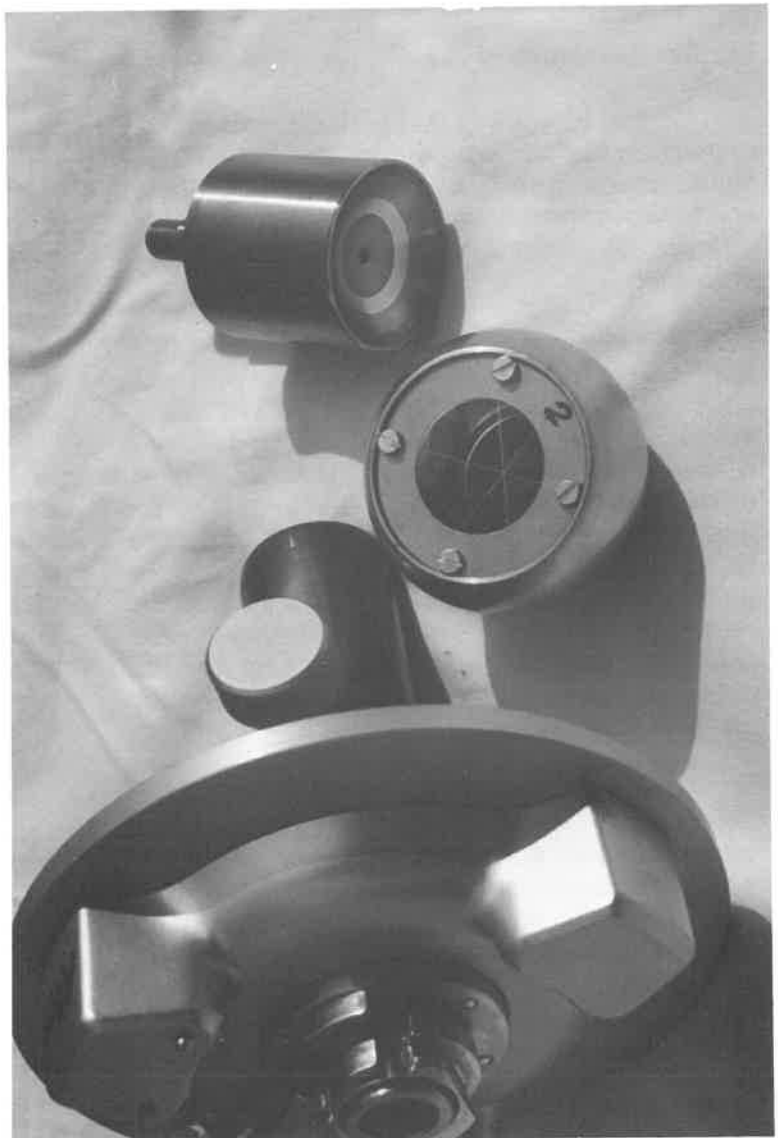
Rétroreflecteur CERN et embase magnétique.
