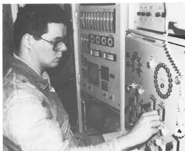
Photo 3 : La cabine de l'opérateur à bord du tunnelier. Notez les boutons pressions en face de l'opérateur. En les actionnant, il peut changer la direction du tunnelier. Les informations du Geodimeter 140 SMS, des détecteurs d'inclinaison, du système de mesures radiales, des caméras TV sont transmises en temps réels dans cette cabine ainsi que vers le bureau de chantier en surface.
