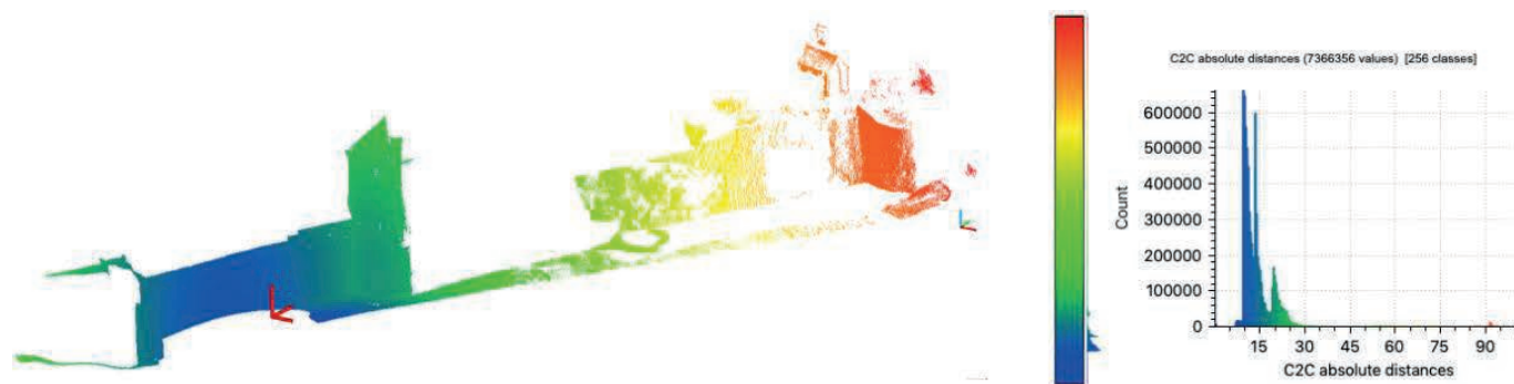
Figure 3. Nuage de points de la muraille romaine du Mans (levé lidar terrestre). À gauche : vue perspective du nuage de points avec un code de couleurs pour les distances de 0,10 m à 102,87 m (le repère rouge indique la position du lidar) ; À droite : histogramme des distances.
