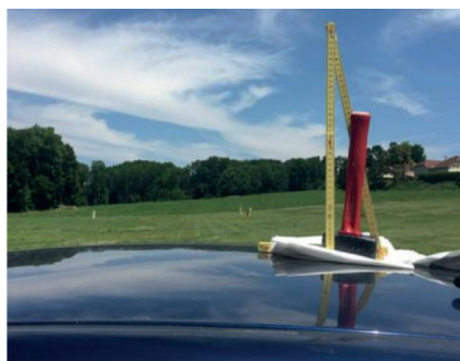
Figure 9. La hauteur de la visée au-dessus du toit de la voiture est mesurée à l'aide d'un double mètre.
