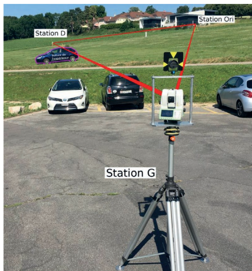
Figure 8. Le canevas se compose d'un triangle d'environ 140 m de côté, dont la base GD rase le toit d'une voiture. La station G est montée sur un trépied réglable en hauteur.
