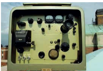
Figure 13. Distance-mètre laser AGA 8 (Geodimeter)
