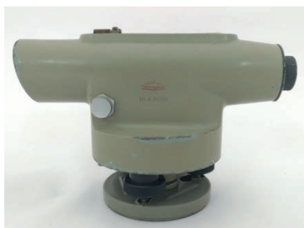
Figure 11. Niveau NLA fabriqué par des entreprises Lemac et Dutzmann.
