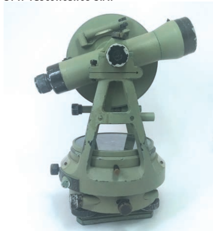
Figure 8. Théodolite M1 fabriqué par la société D. F. Vasconcellos S.A.
