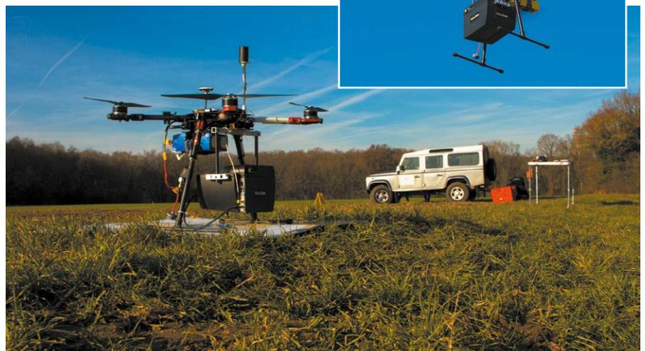
Figure 5. Drone DPS4-Urban équipé du capteur LiDAR MAPPER
