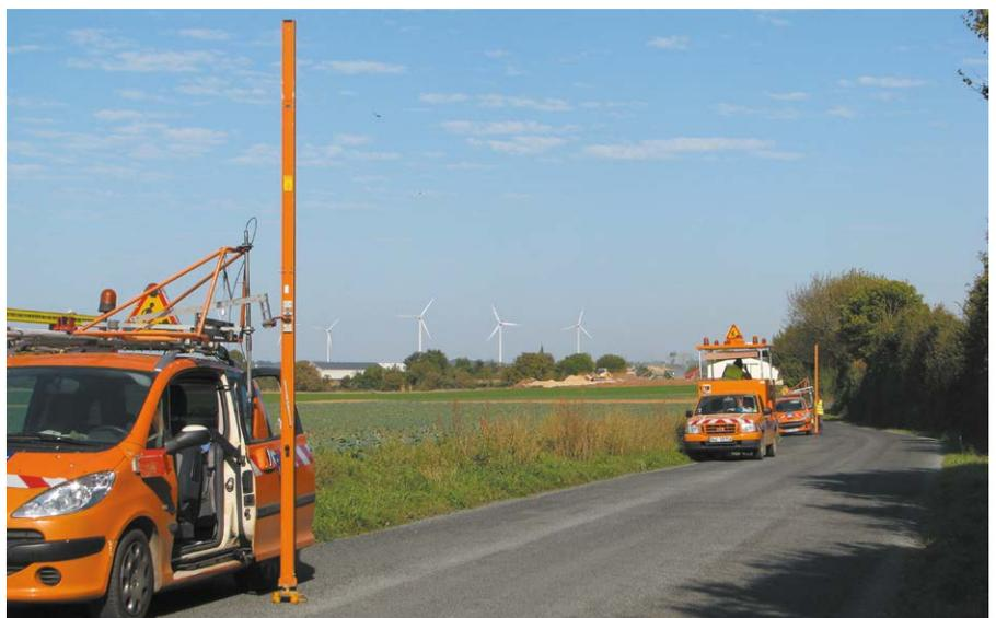
Figure 2. Nivellement motorisé (NIGEMO).
