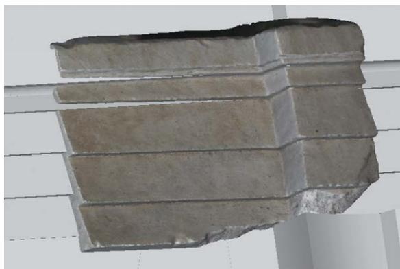
Figure 6. Portion du modèle de reconstruction fait sur la base des dessins avec incrustation du bloc numérisé, mise en évidence du décalage (max 6 cm).
