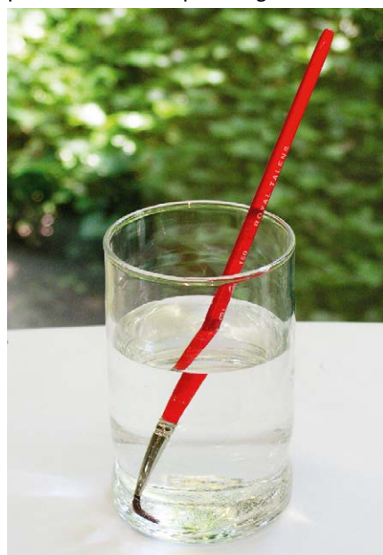
Figure 1. Représentation de la loi de Snell-Descartes dans le cas discret. Le chemin optique est dévié par la traversée de trois milieux - l'air, le verre et l'eau - dont les réfringences sont nettement différentes. [ https://fr.wikipedia.org/wiki/Réfraction ]
