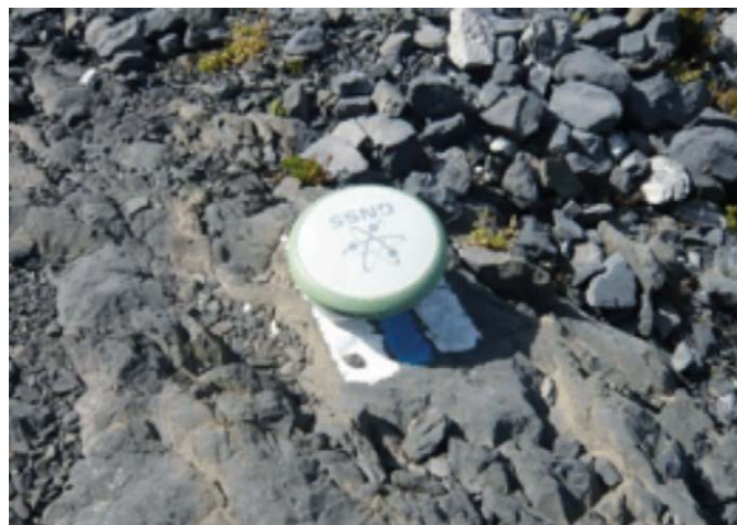
Figure 3. Mesure d'une marque de peinture d'un sentier balisé en GNSS RTK
