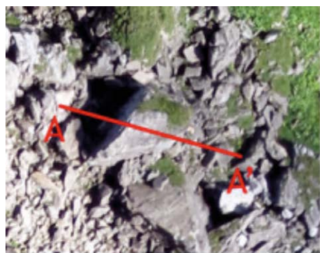
Figure 7. Exemple de la coupe A-A' effectuée dans un secteur rocheux. (a) image du terrain, (b) différence des MNT à pas de 5 cm (bleu) et 20 cm (brun) pour des versions différentes de Pix4D, (c) avec la même version. On note que les principales erreurs entre versions différentes du corrélateur photogrammétrique sont dans des zones à l'ombre.
