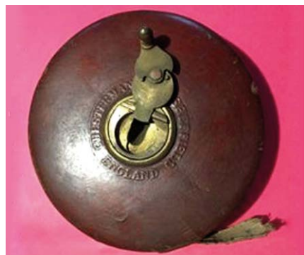
Figure 4. Le décamètre ruban de toile dont l'usage était limité par la boue qui bloquait l'enroulement.
