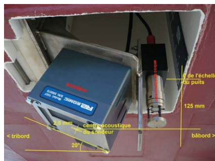
Photo 6. Montage du sondeur 2020 à bord du Bourgidou. Vue prise sous la coque, vers le haut et l'arrière du bateau
