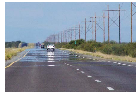
Figure 10. Image typique d'une route par temps chaud. Le mirage démontre la présence d'un coefficient k négatif. Avec nos propres yeux, l'image vibrerait. Cet effet de scintillation est dû aux brusques variations de k dans le temps.
