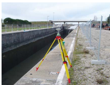
Photo 3. Détermination du point de station ESGD par GNSS NRTK moyenné parfaitement connus en planimétrie, en projection Lambert 93, et en altimétrie, en altitudes NGF-IGN69.
