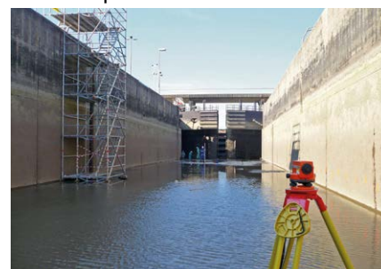
Photo 4. Nivellement du point de station ESGR
