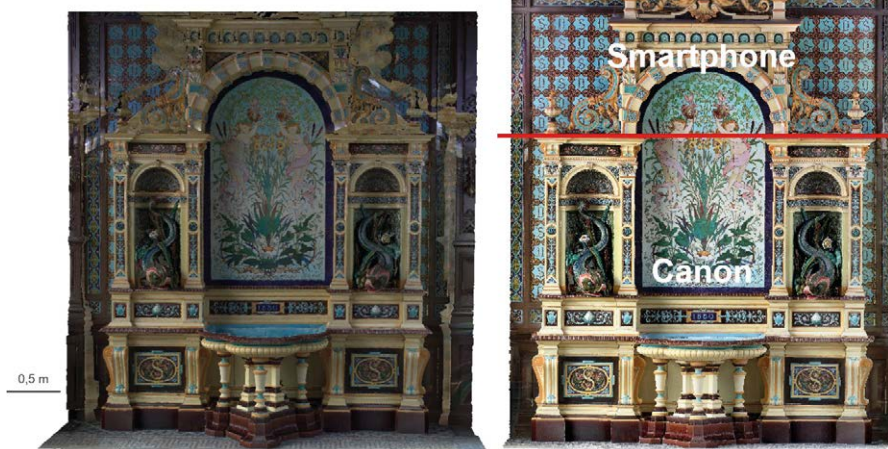
Figure 7. Fontaine sans prétraitement d'images (à gauche) et fontaine avec égalisation d'histogramme (à droite)
