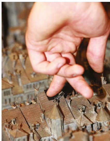
Figure 5. Pose des cibles sur le Relief Magnin
