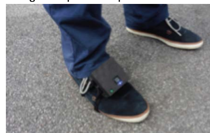
Figure 2. Centrale d'acquisition PERSY attachée au pied
