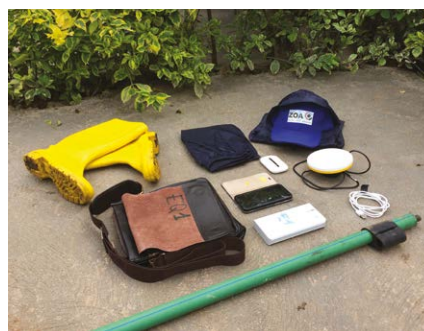
Figure 7. Unité complète de collecte sur le terrain comprenant bottes, pantalon et veste de pluie, couvre-chef, canne, récepteur GNSS Trimble Catalyst, smartphone, batterie externe, sac de rangement et modem 4G ; la boussole, toujours utile au repérage, restant discrètement dans la poche du géomètre
