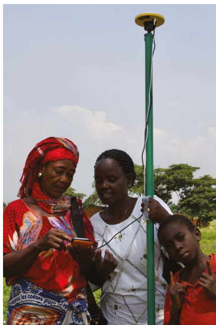
Figure 6. Les représentantes des villages et des femmes apprennent à se servir des unités de collecte. Les perches ont été fabriquées localement au moyen d'un tuyau PVC et d'un embout fileté permettant de visser le Catalyst sur la perche ; coût : 10 euros !
