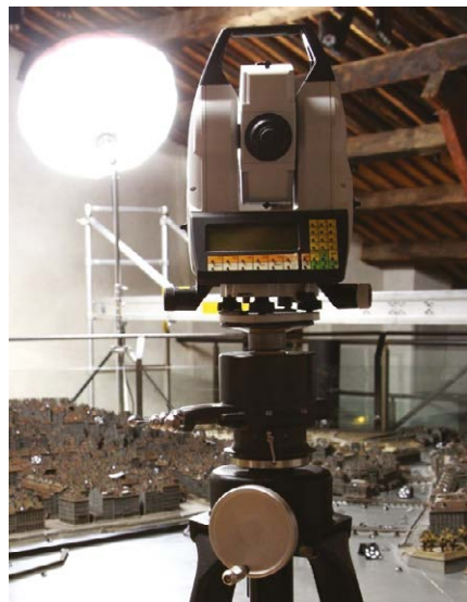
Figure 4. Vérification de la stabilité du Relief (TDA 5005)
