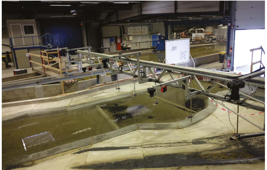
Figure 3. Chariot instrumenté du modèle physique
