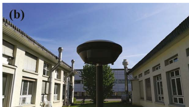
Figure 4. Installation test dans un environnement avec d'importants multitrajets à Heerbrugg (mobile : GS16, hauteur d'antenne : 1.8 m) (a) vue depuis le Sud, (b) vue depuis le Nord.
