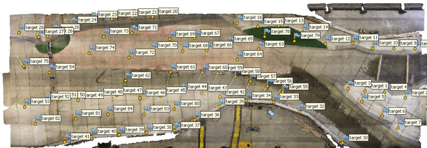
Figure 8. Vue de haut du modèle et de la disposition spatiale des cibles PVC
