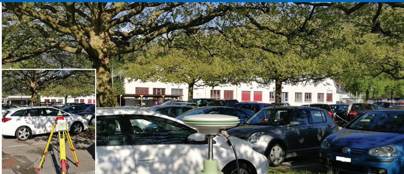
Figure 7. Installation test sous canopée à Heerbrugg (mobile : GS10, antenne : AS10).
