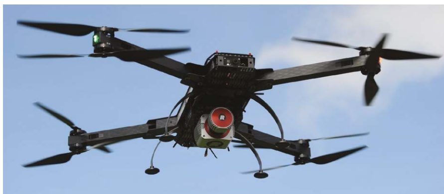
Figure 1. Drone RiCOPTER et système LiDAR VUX-1 UAV en vol.
