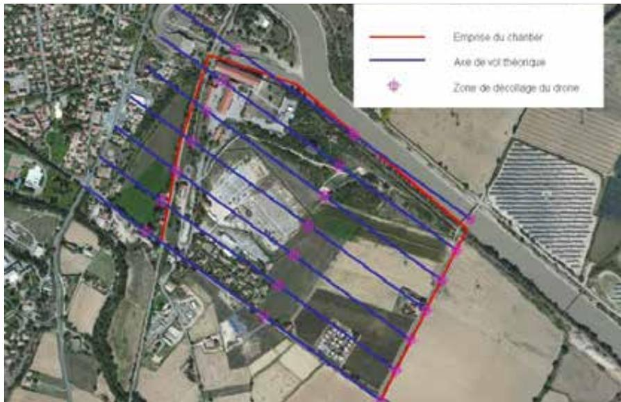
**Figure 4.** Zone du relevé et plan de vol
