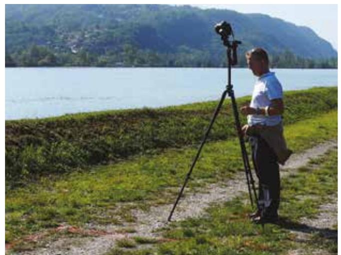
Figure 11. Exemple de zone de placette, avec nivellement des GCP et prise de vue photogrammétrique
