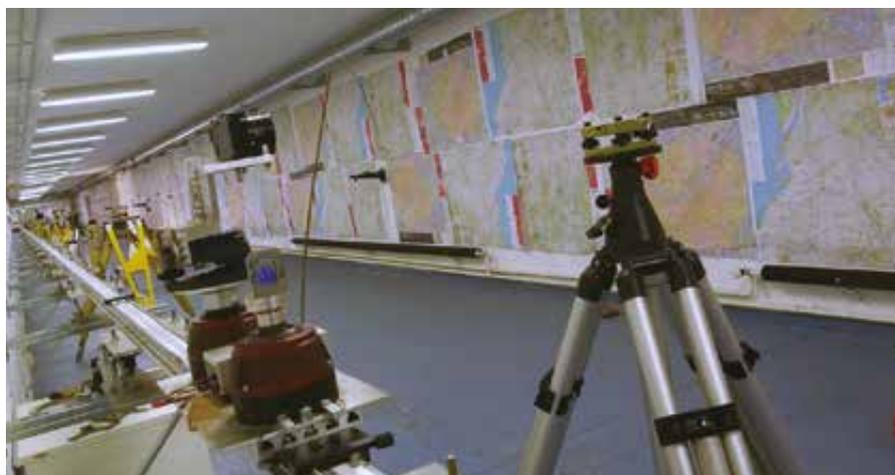
Figure 3. À gauche, le rail reproduisant le vecteur aérien ; à droite, le mur reproduisant l'ouvrage linéaire à ausculter
