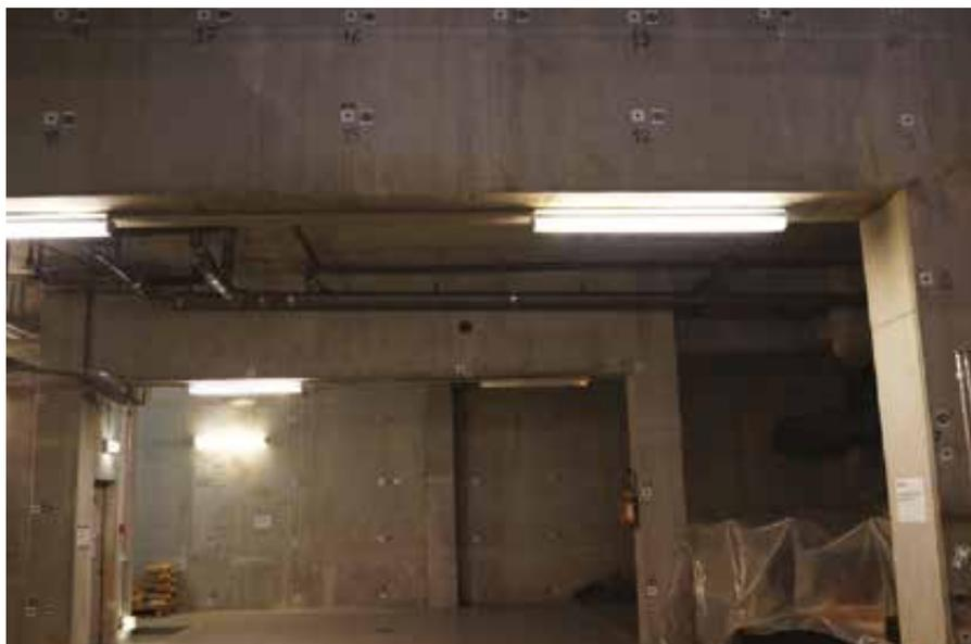
Figure 6. Polygone de calibration de l'ENSG
