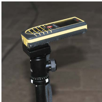
Figure 2. Le distancemètre sur sa rotule
