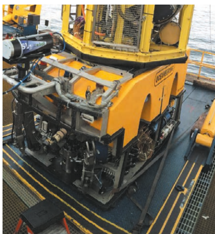
Figure 4. Installation du scanner sur le ROV (SBM Installer, 21 juin 2015).
