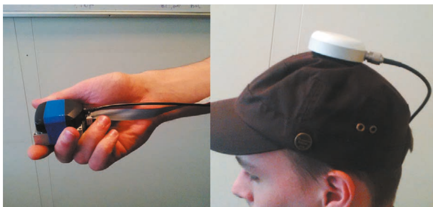
Figure 4. Dispositif expérimental. Une centrale inertielle et magnétique et un récepteur GNSS dans la main. Un récepteur GNSS géodésique avec antenne sur la tête qui fournit la vitesse de référence calculée en mode différentiel.
