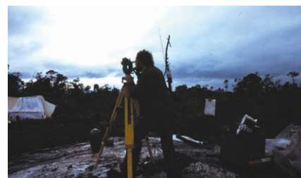
Figure 22. Michel Le Pape observe au T3. instructions qui nous étaient données : j'avais compris que nous établissions un réseau de trilatération (basé donc sur des mesures de distances) ; puis Hervé Guichard, chef de mission désigné en cours d'opération, a imposé des mesures azimutales, ce qui sur un plan pratique et logistique, modifiait de fait énormément les durées de séjour sur les points. Puis l'instruction a été donnée d'effectuer des lectures de bulle sur la nivelle du théodolite lors des tours d'horizon ou de mesures de couple. J'avoue qu'à l'époque je comprenais mal ces directives, constatant, le terrain étant tellement boueux, qu'on pouvait centrer à coup de pied la borne sous le théodolite...
