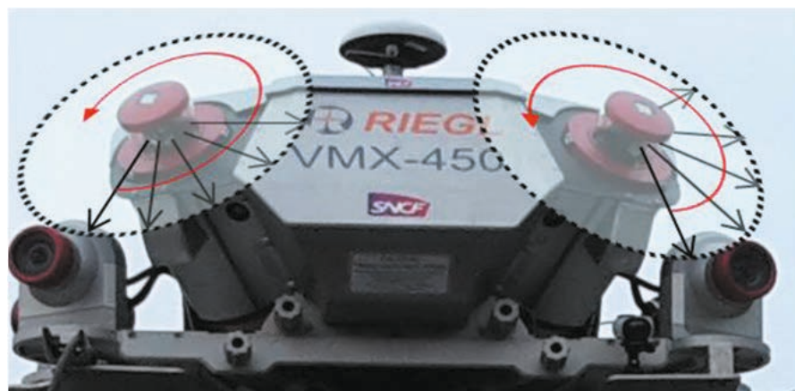
Figure 2. Représentation de la configuration des scanners laser VQ-450 en forme de "X".
