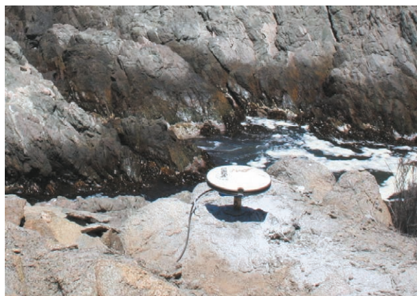
Figure 4. Point géodésique en centrage forcé sur un marqueur.
