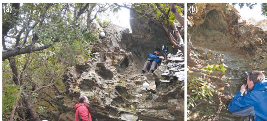
Figure 2. (a) Scanner Faro Focus 3D à mi-hauteur de la paroi et (b) relevé photo à 7 m du sommet du surplomb rocheux.
