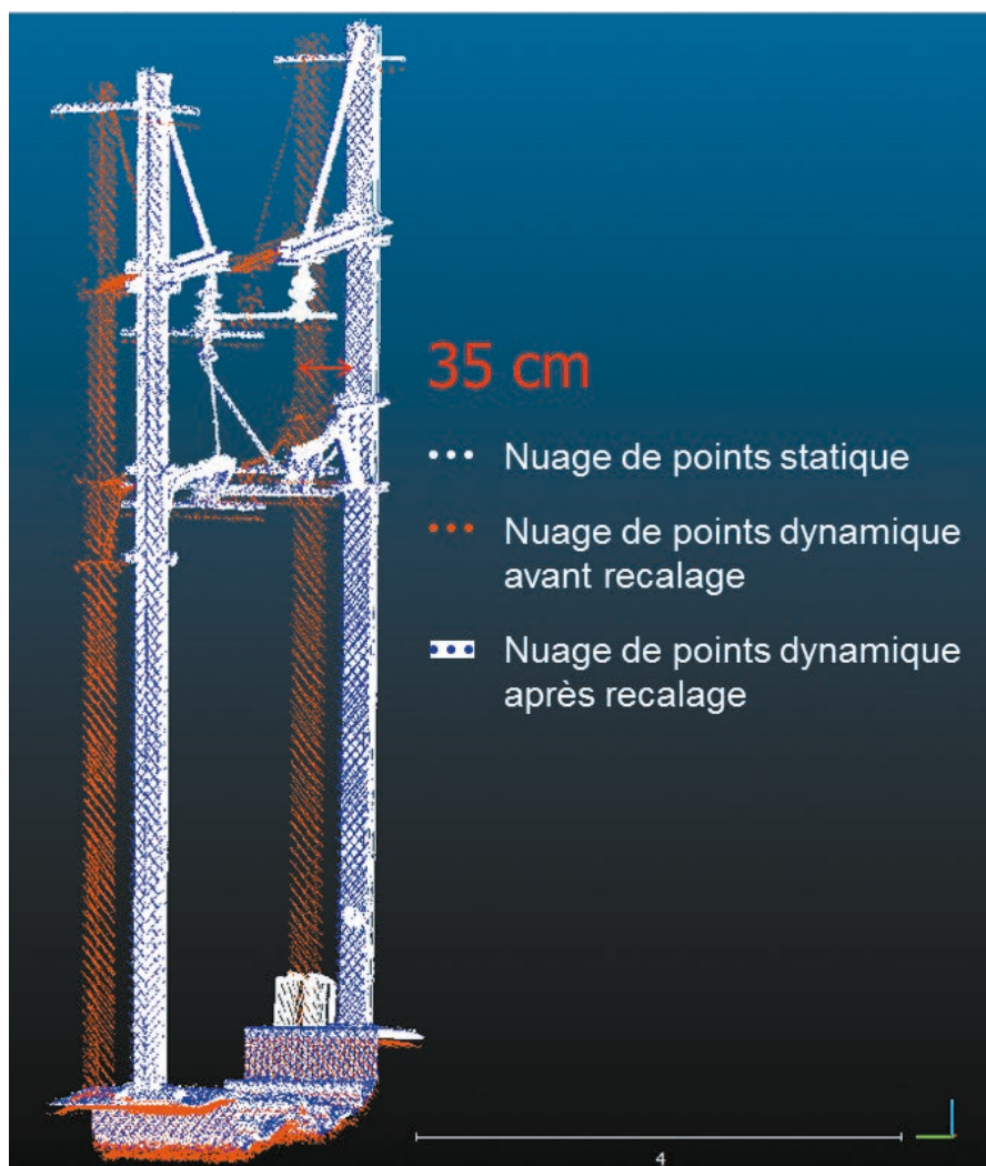
Figure 8. Visualisation des écarts entre le nuage de points statique et les nuages issus de levés dynamiques avant et après recalage, au niveau d'un poteau caténaire.
