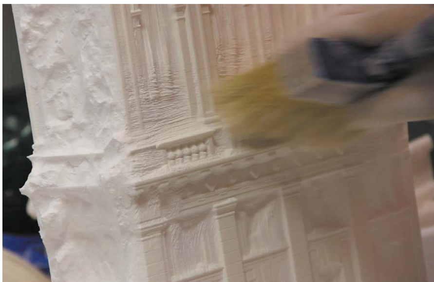
Figure 10. Nettoyage des parties du modèle imprimé
