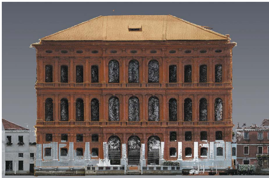
Figure 6. Comparaison des données des relevés du palais et de la maquette
