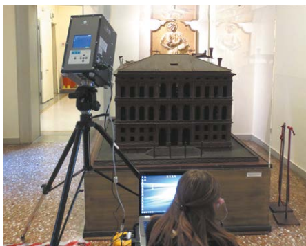
Figure 5a-b. Acquisitions par photogrammétrie et balayage laser de la maquette en bois
