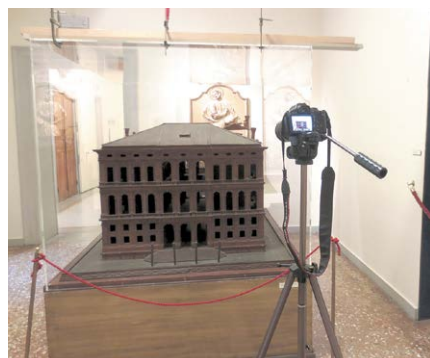
Figure 5a-b. Acquisitions par photogrammétrie et balayage laser de la maquette en bois
