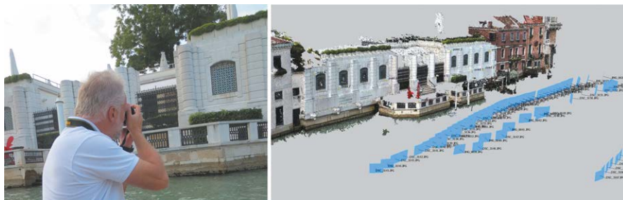
Figure 4. Étapes du relevé photogrammétrique
