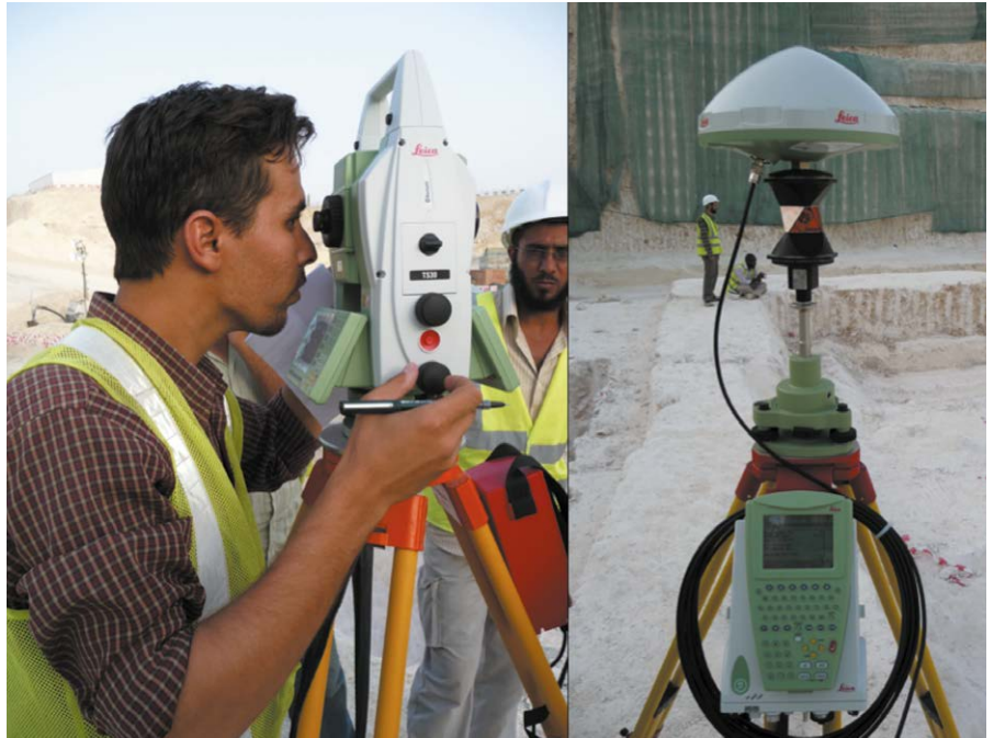
Le système des "points GNSS actifs" en œuvre pour la tour CMA de Riyad, Arabie Saoudite
