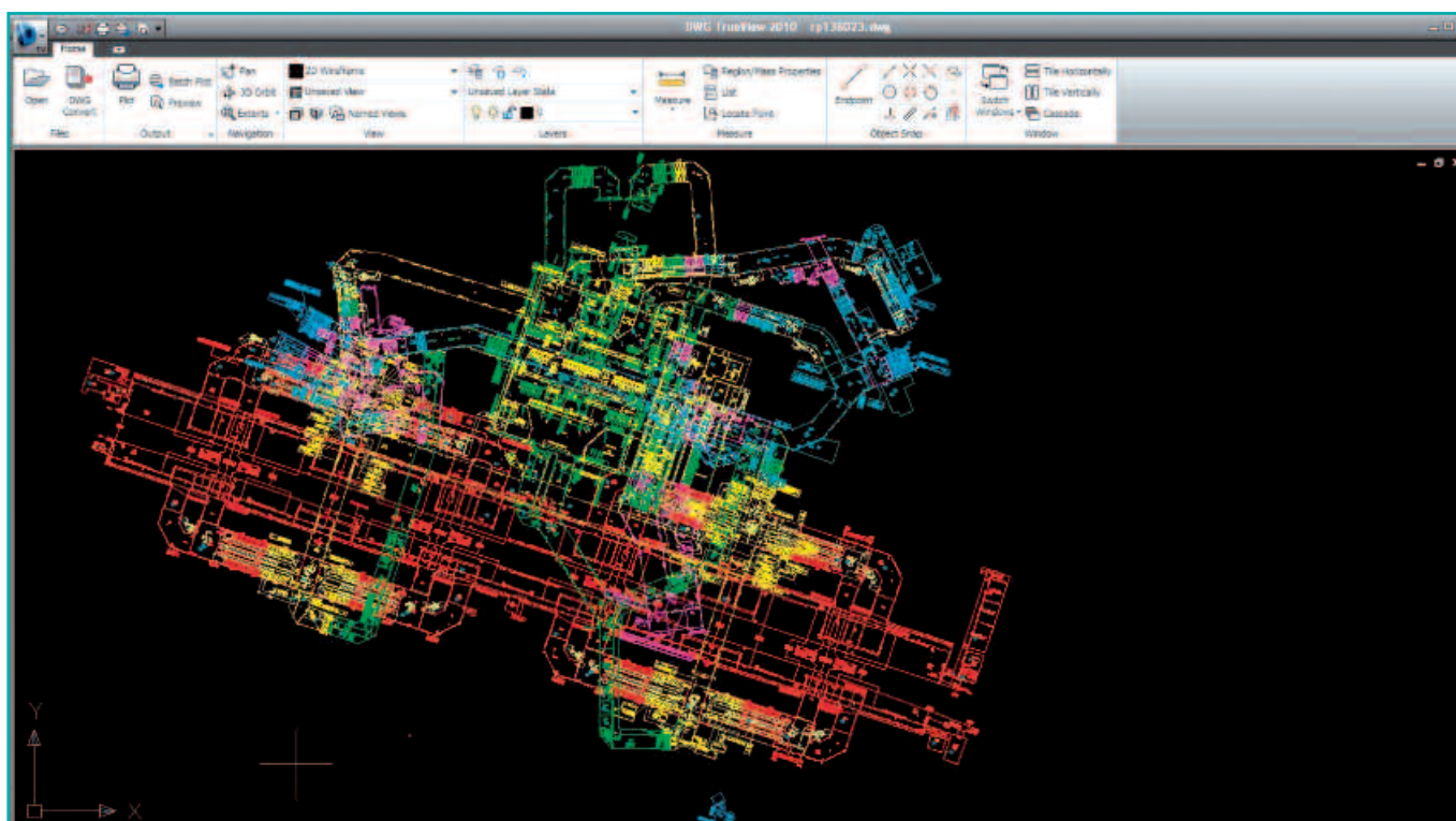
Plan Autocad d'origine de la station Nation avant transformation dans le SIG 3D avec l'outil FME par la société IDS.
