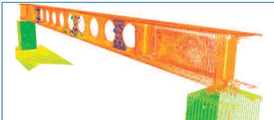
Figure 6. Aperçu des scans produits par le scanner de détails, fusionnés avec ceux de la ScanStation2.
