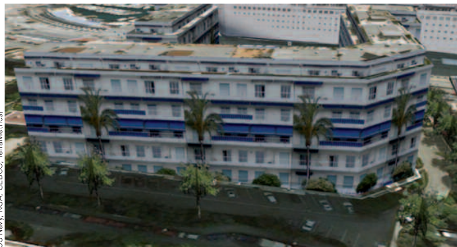
Figure 1. Illustration de l'impact d'un MNT de précision insuffisante pour une adaptation parfaite du bâtiment sur le sol : le rez-de-chaussée devient partiellement masqué par le terrain
