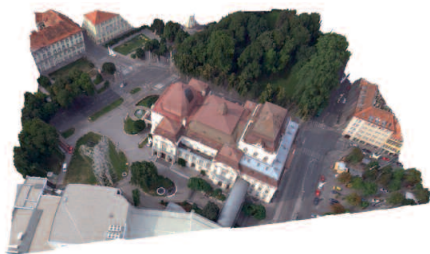
Figure 2. Modélisation 3D générée à partir d'un MNS texturé créé par une méthode de corrélation multi-vue dense (source : Irschara et al, 2012)
