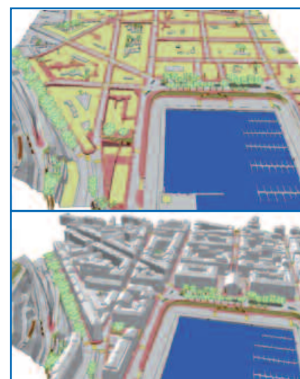
Figure 8. Représentation schématique de la modélisation classifiée du sol et du sursol (avec et sans bâtiments)
