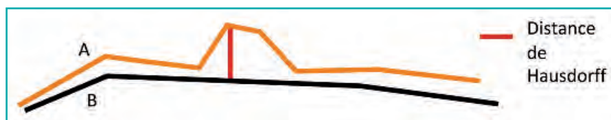
Figure 5. Schéma décrivant l'indicateur de distance de Hausdorff
