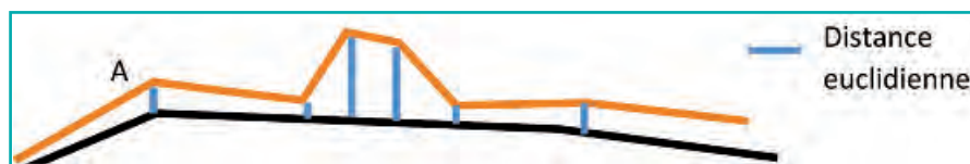
Figure 6. Schéma décrivant l'indicateur de distance euclidienne moyenne
