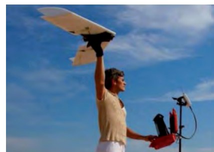
Figure 4. Drone Lheman au décollage. Source : [Pierrot Deseilligny, 2011]
