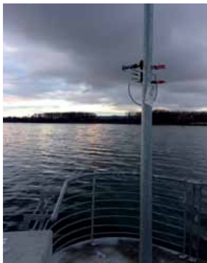
Figure 3. Installation de la campagne d'acquisition du 22 novembre 2013. On remarque l'antenne, fixée avec son axe horizontal pointant vers le lac.
