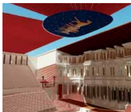
Figure 12. Le vélum à anneau de cordes agrémenté d'une toile centrale
